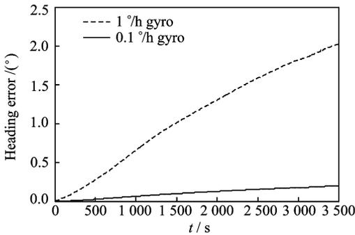
Fig. 5 Heading error
