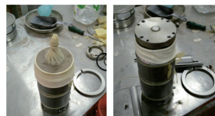
(d) Completion of soil compacting
